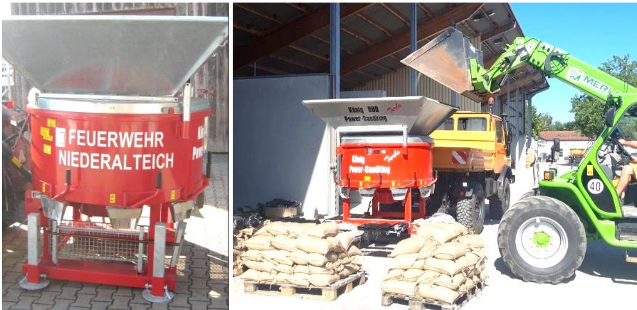
Sandsackfüllanlage Power Sandking 800 (Fa. König)
