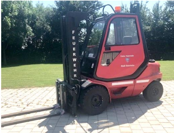
Stapler Osterhofen: Hebelast 3,5 Tonnen
