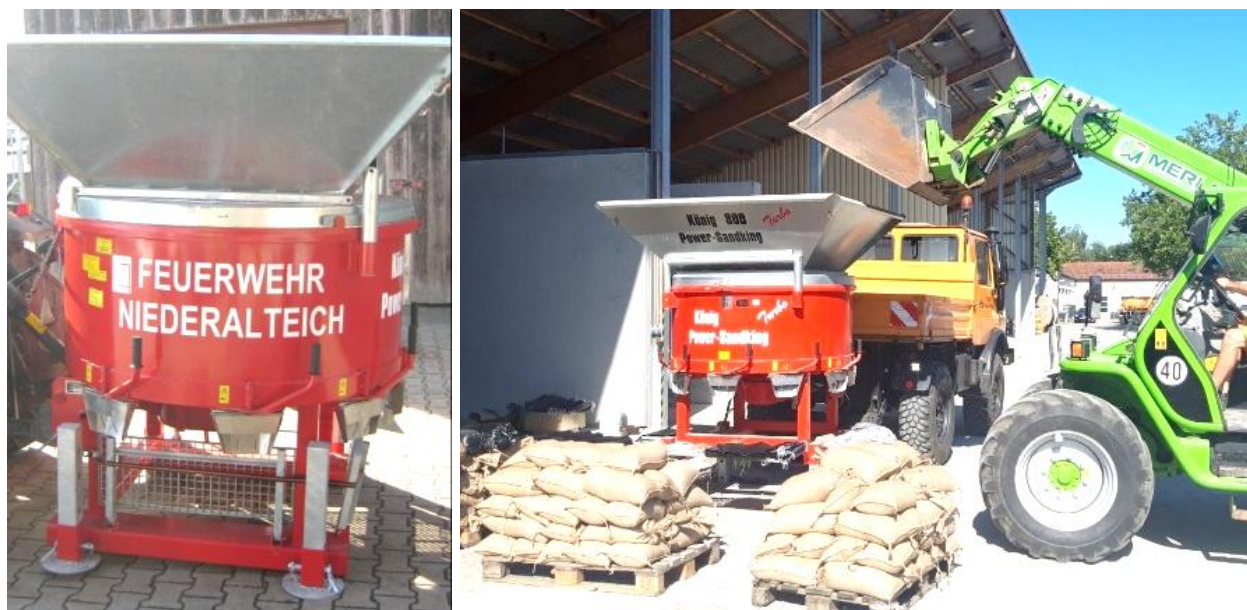
Sandsackfüllanlage Power Sandking 800 (Fa. König)
