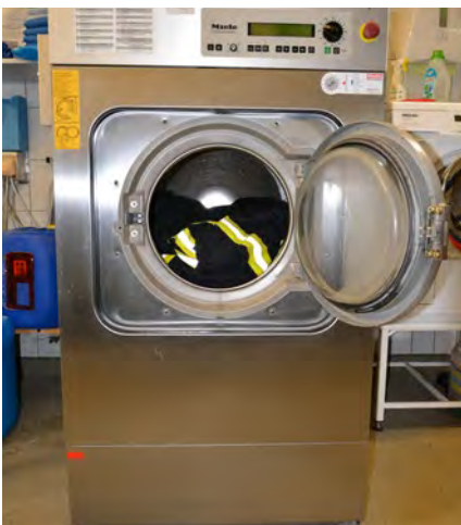
Abb. 24a Beispiel einer für Feuerwehrschutzkleidung geeigneten Industriewaschmaschine
