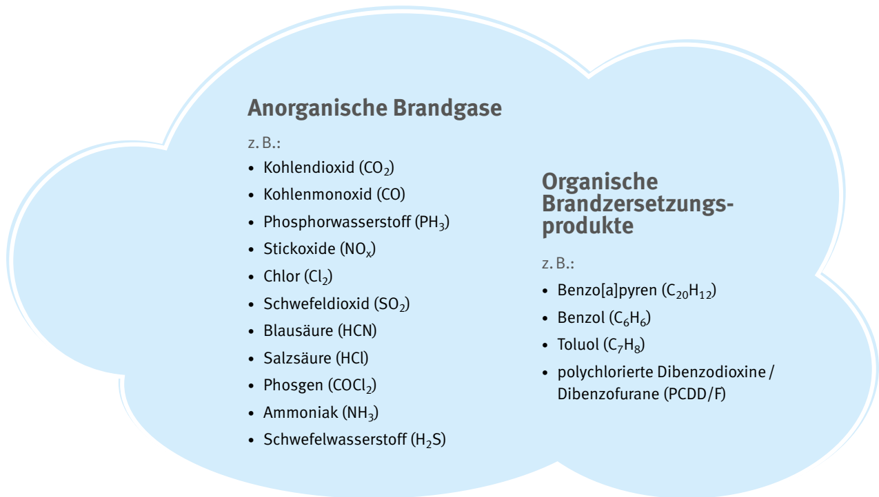
Abb. 3 Typische Zusammensetzung von Brandrauch
