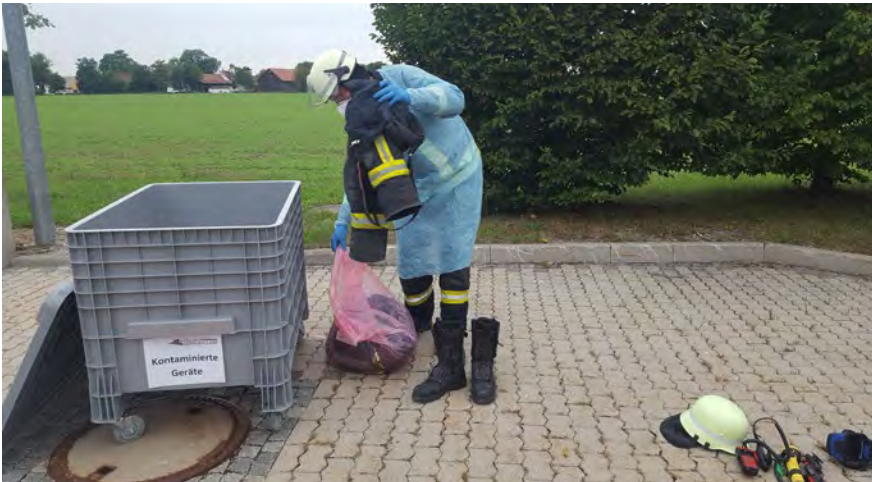
Abb. 20a Heißwasserlöslicher Wäschesack für maschinenwaschbare Feuerwehrsutzbekleidung, diese können z. B. in der abgebildeten, verschließbaren Wanne gesammelt und transportiert werden.
