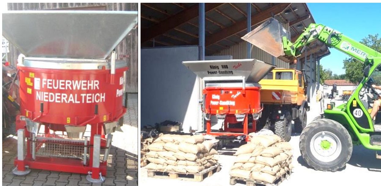
Sandsackfüllanlage Power Sandking 800 (Fa. König)
